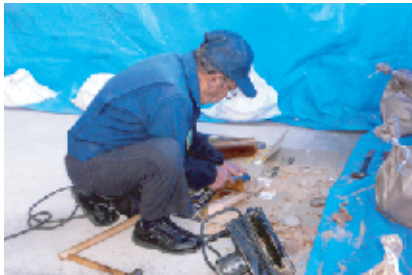
餅つきに欠かせない杵の修理。痛んだ部分をきれいに削っておかないと、餅の中に木屑が交じってしまいます。
